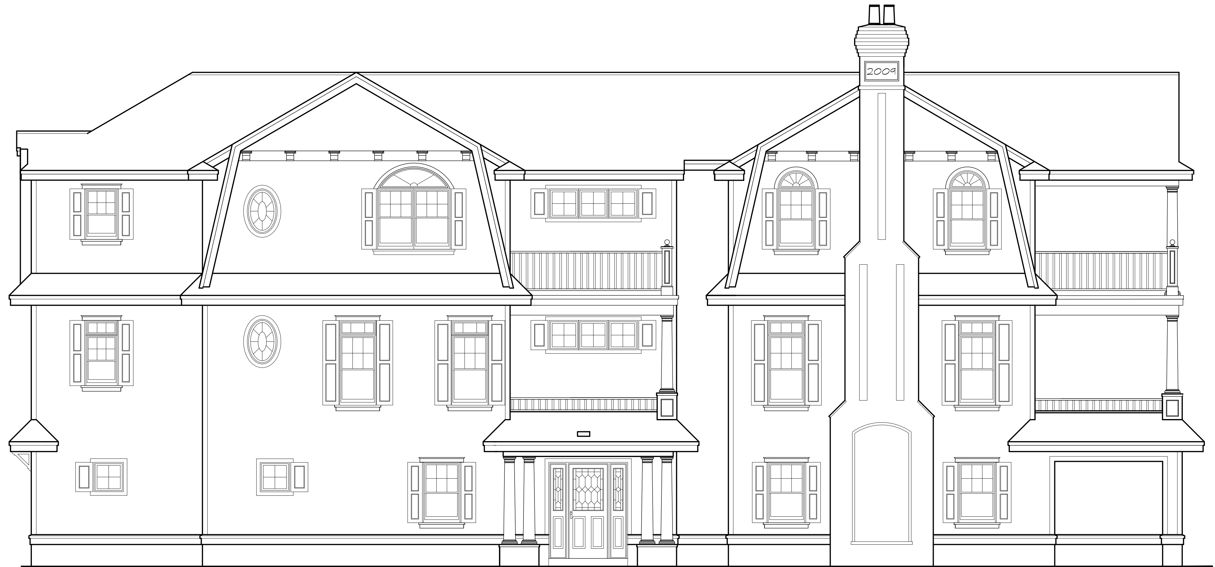
4 RIGHT SIDE ELEVATION DD SCALE: 1/8" = 1'-0"
